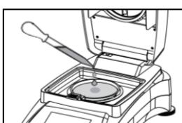
Coloque la bandeja de muestras vacía y la bandeja de fibra de vidrio en el asa / tirador de la bandeja. La bandeja de muestras debe colocarse plana dentro del asa / tirador de la bandeja.
