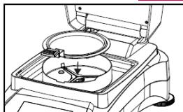
**Notera:** Det är lämpligt att du arbetar med pann handtaget hela tiden. Pann handtaget är ergonomiskt, säkert och ger skydd mot eventuella brännskador på grund av en varm provskål.
